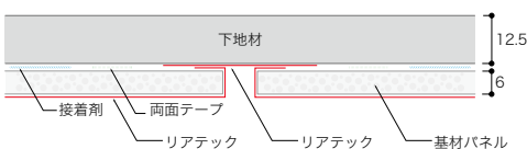
納まり図 ※数値は一般的な例になります。(単位:mm)
