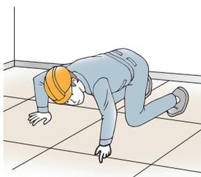
特に接着剤を使用する施工は、接着剤が硬化する前に注意深く点検し補修します。
