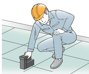
湿度の上昇が想定される場所では強アルカリ化した水分の影響により臭気の発生や接着力の低下、それに伴う目地隙、剥がれ、膨れ、突き上げなどの現象が生じる可能性があります。これらの現象を抑えるためには下地をよく乾燥させ、下地の含水率を8%以下にしてください。
